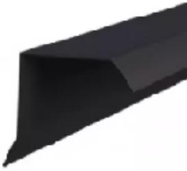
Für die dauerhafte Haltbarkeit Ihrer Dacheindeckung ist es erforderlich die Fugen zwischen der Dacheindeckung und der Dachblenden abzudecken, um zu verhindern, daß Feuchtigkeit eindringt und sich die Dacheindeckung löst. Die Blendenabdeckung ist aus verzinkten pulverbeschichteten Stahl und schützt nicht nur die Dachblenden von Flach- und Pultdächern vor Feuchtigkeit, sondern bietet ebenfalls einen sauberen und optisch ansprechenden Dachabschluß.
